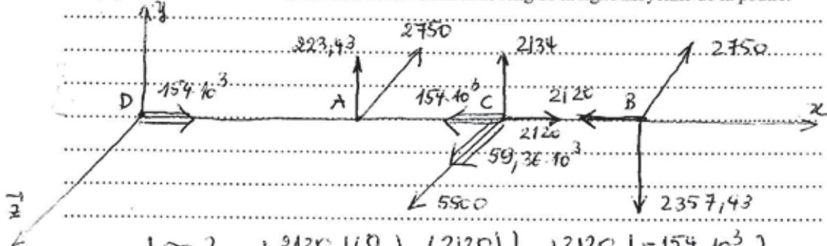
$$\{G_3\}_C = \begin{Bmatrix} 2120 \\ 2134 \\ 5500 \end{Bmatrix} \left( \begin{matrix} 0 \\ -29 \\ 0 \end{matrix} \right) \wedge \begin{Bmatrix} 2120 \\ 2134 \\ 5500 \end{Bmatrix} = \begin{Bmatrix} 2120 & -154 \cdot 10^3 \\ 2134 & 0 \\ 5500 & 59,36 \cdot 10^3 \end{Bmatrix}_C$$
