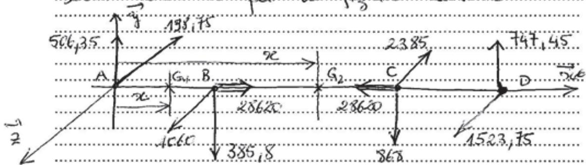
\* Coupure entre A et B  $0 \leq x_{G_1} \leq 15$  (mm).
