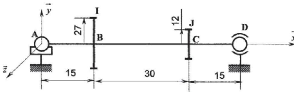
L'arbre est soumis aux actions mécaniques extérieures suivantes, respectivement à l'entrée et à la sortie :
