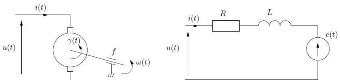
La modélisation de la commande en vitesse de l'ensemble mécanique est obtenue en utilisant les équations différentielles suivantes, numérotées de 1 à 4 :
