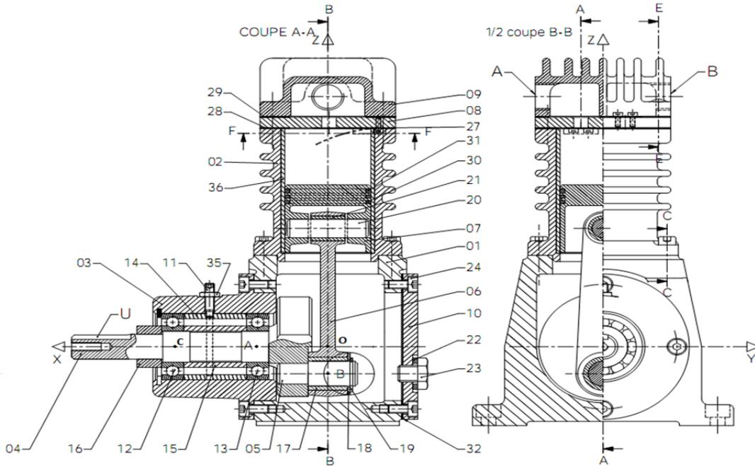
Figure 2 : Dessin d'ensemble en coupe du compresseur mono-piston.
