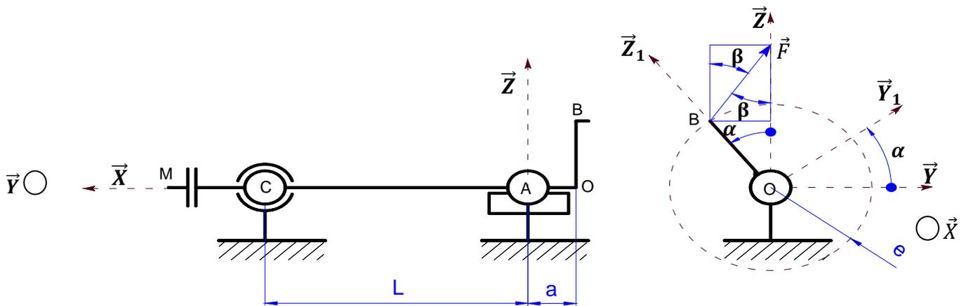
Figure 2 : Schéma cinématique de l'ensemble isolé(S).
