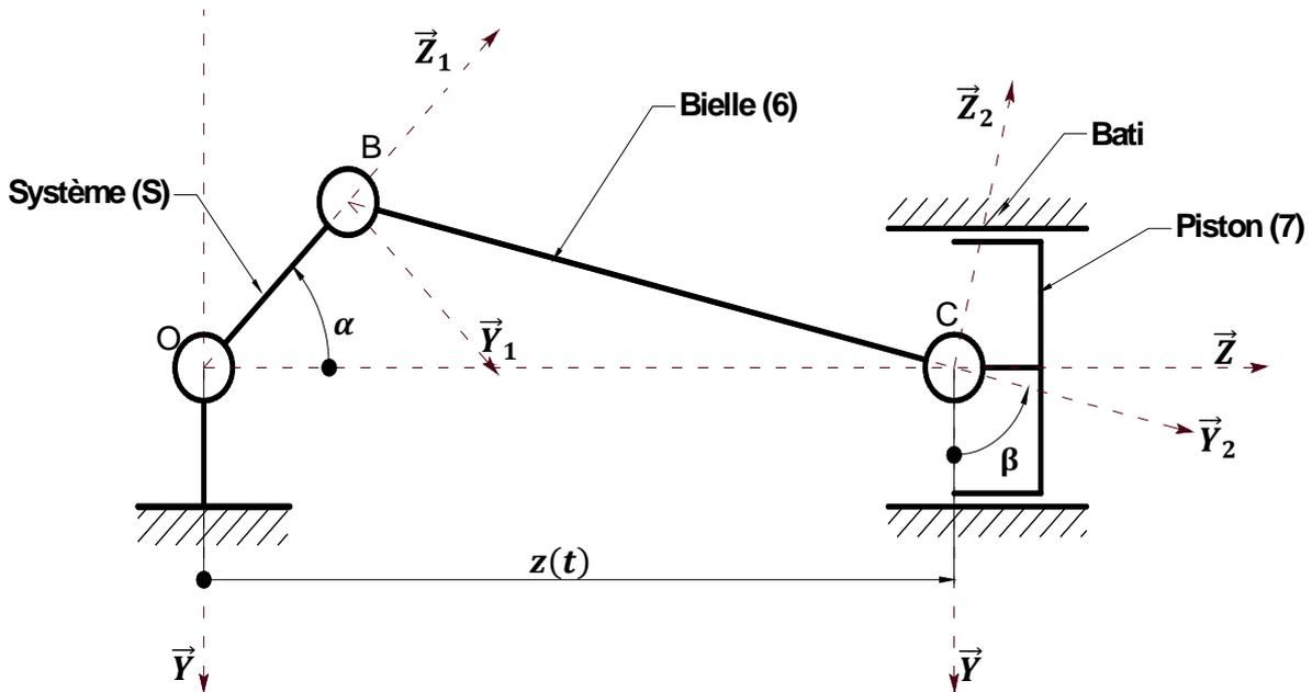
Figure 4 : Schéma cinématique du système bielle manivelle
