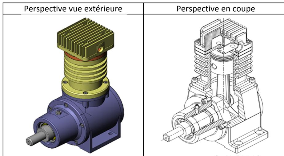
*Figure 1 : compresseur mono-piston vue extérieure et perspective en coupe.*
